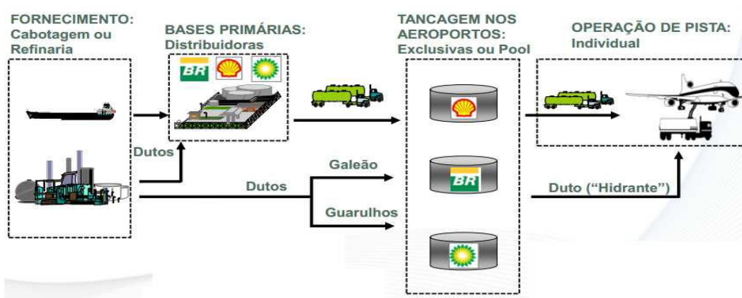
Figura 3: Esquema de Distribuição do QAV no Brasil, desde o fornecedor da matéria-prima até o abastecimento da aeronave.
