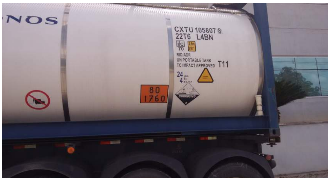
Figura 5.2.9 As placas de identificação podem ser colocadas nas laterais, na parte dianteira e na parte de trás do veículo.
